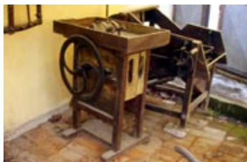
Macchina per sgranare le pannocchie al Museo “I Rubat” di Piscina
